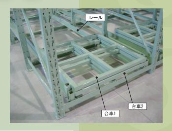
**プッシュラックとは…** 同一商品を大量に管理するのに適したラックです。 パレットを載せた台車がレール上を移動し、前面 からのパレット出し入れを行います。 先入れ後出し管理となります。 パレット1枚当たり 耐荷重 1000kg
