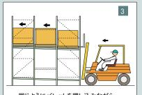
同じようにパレットを押し込みながら、 最後のパレットをレールに載せます。
