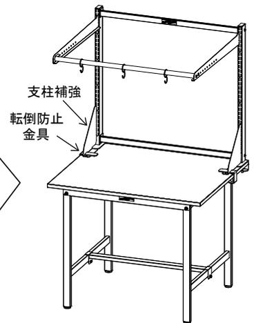
⑤必ず支柱補強及び転倒防止金具を取付けてください。
